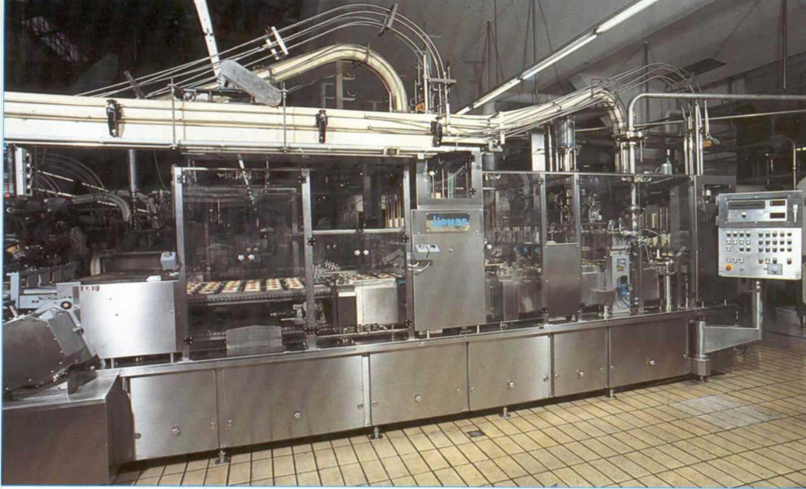
Modern tesislerde kullanılan bir kase margarin dolum hattı
