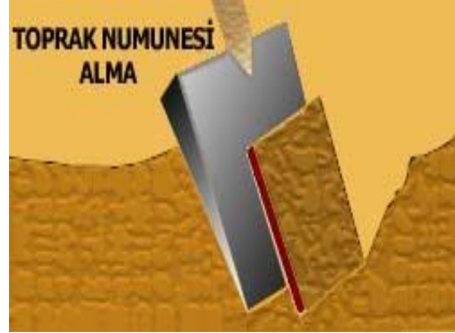
Şekil 2 Toprak numunesi almak için sondaj, bürge, Etek gibi birçok alet kullanılır.
